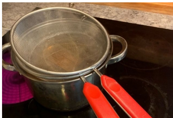
Ar glicerīnu uzpildīts katls termokoksnes iegūšanai
