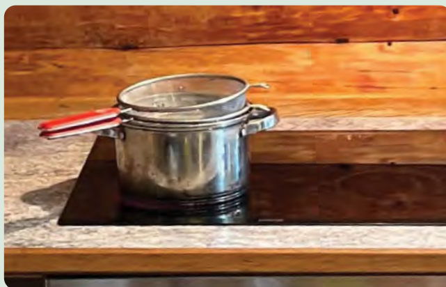
Ar glicerīnu uzpildīts katls termokoksnes iegūšanai.
