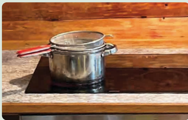
Ar glicerīnu uzpildīts katls termokoksnes iegūšanai.
